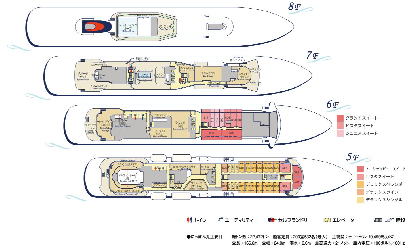
●にっぽん丸主要目 総トン数: 22,472トン 船客定員: 203室532名(最大) 主機関: ディーゼル 10,450馬力×2 全長: 166.6m 全幅: 24.0m 喫水: 6.6m 最高速力: 21ノット 船内電圧: 100ボルト/60Hz
